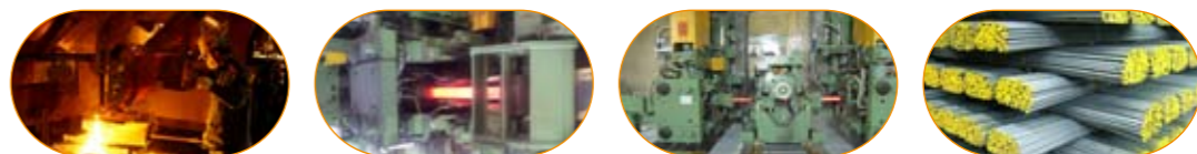
1. 가열 2. 압연 3. 냉각 및 절단, 포장 4. 생산제품
